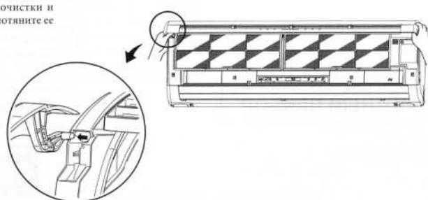
Закрепите верхний или нижний край панели воздухоприемника, путем легкого нажатия на нее, а затем закройте панель.
